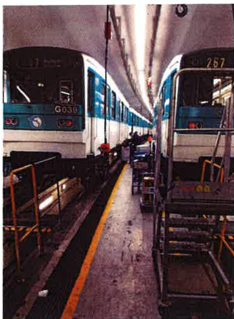
Figure 5 : Voies sur fosse de l'Atelier de Maintenance des Trains d'Auteuil (Source : RATP)
